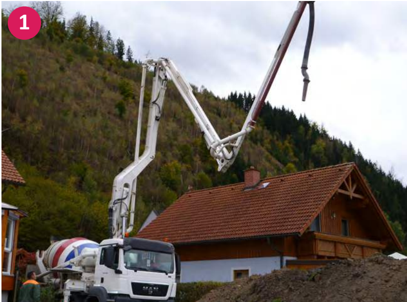
▲ Betonwagen mit Betonpumpe
